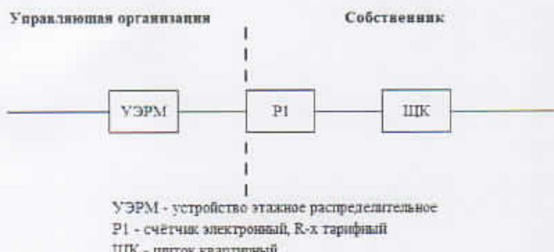
Исполнитель несет ответственность за надлежащее состояние и работоспособность питающих электрических сетей на квартиру согласно инклюзированной схеме до прибора учета (пунктирной линии слева).
