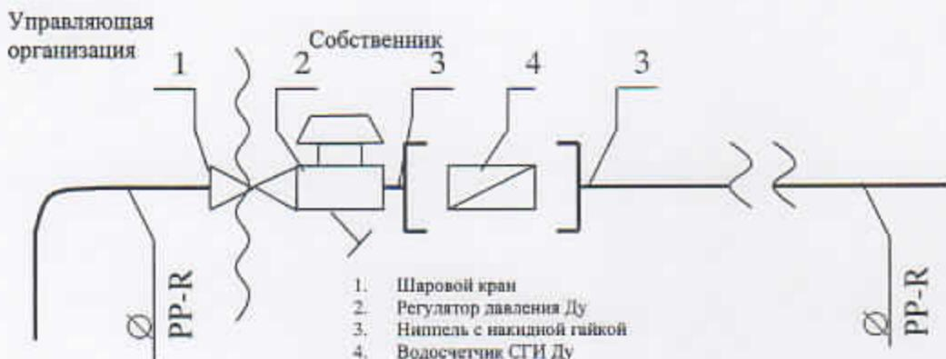
Исполнитель несет ответственность за надлежащее состояние и работоспособность систем горячего и холодного водоснабжения согласно инклюзированной схеме до волнистой линии слева (включая шаровой кран).
